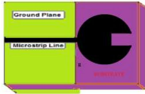
Fig. 1(a): UWB Antenna.
